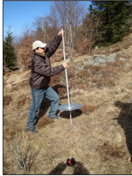
Abb. 15-16: Mess-Kubus für die Anwendung der Cube-Methode Calluna vulgaris (links) und Anwendung des Disc Pasture Meter auf Weideflächen im Schwarzwald (Fotos: Arbeitsgruppe Feuerökologie/GFMC).
